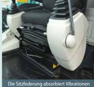
Die Sitzfederung absorbiert Vibrationen
